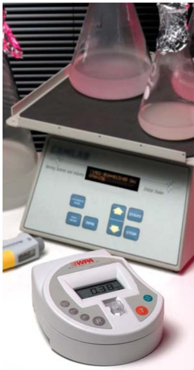
Le mesureur de densité cellulaire CO 8000 est compact, portable et simple d'utilisation pour la mesure des cellules de levures ou de bactéries type E. Coli en suspension à 600nm. Il a été conçu spécialement pour l'obtention de mesures comparables aux autres spectrophotomètres. Idéal pour les cultures cellulaires en fioles coniques de 200ml à 5 litres, le CO 8000 peut être utilisé directement à côté du lieu de culture, dans un incubateur, sous une hotte ou même en conditions anaérobies.
