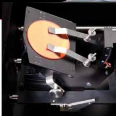
*Insert de mesure de réflexion avec angle variable pour les déterminations de l'indice de réfraction et de l'épaisseur de couche*
