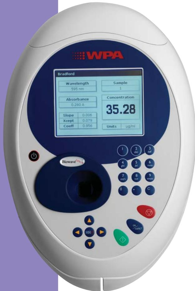
Le Biowave DNA est spécialement conçu pour les applications de Sciences de la Vie et s'avère un outil puissant pour tous les laboratoires à la recherche d'un appareil dédié pour la détermination de la pureté et de la concentration des acides nucléiques, protéines ou de la densité cellulaire.
