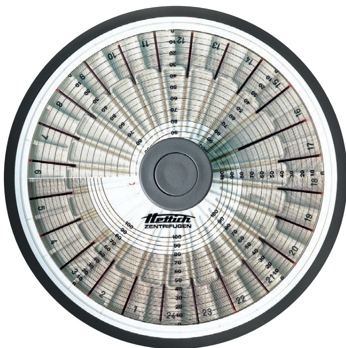
Un coup d'œil dans la cuve pour découvrir le rotor 2076 avec couvercle servant de disque de lecture
